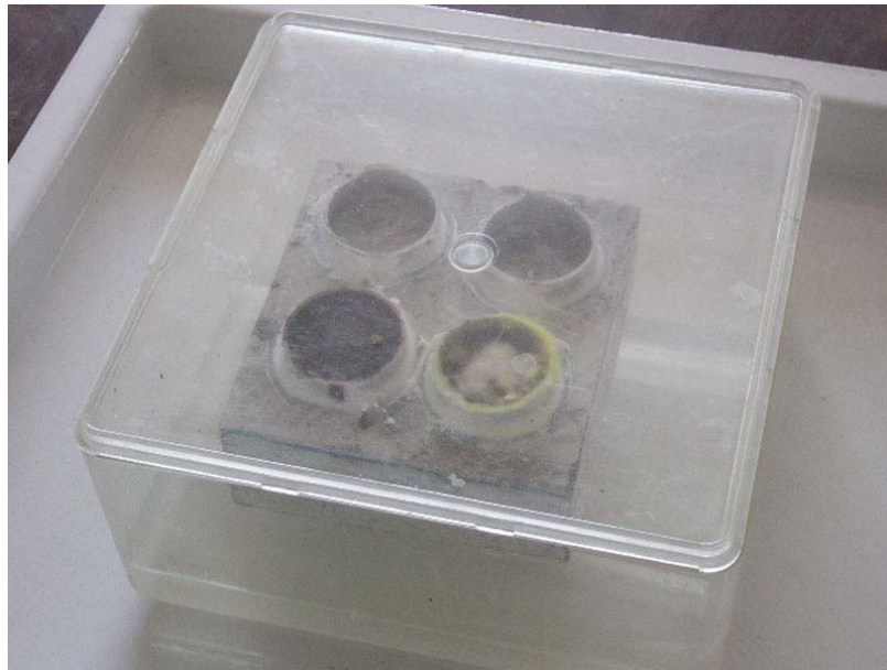
Bild 14: Probe in Plastik-Box über Wasser gelagert
