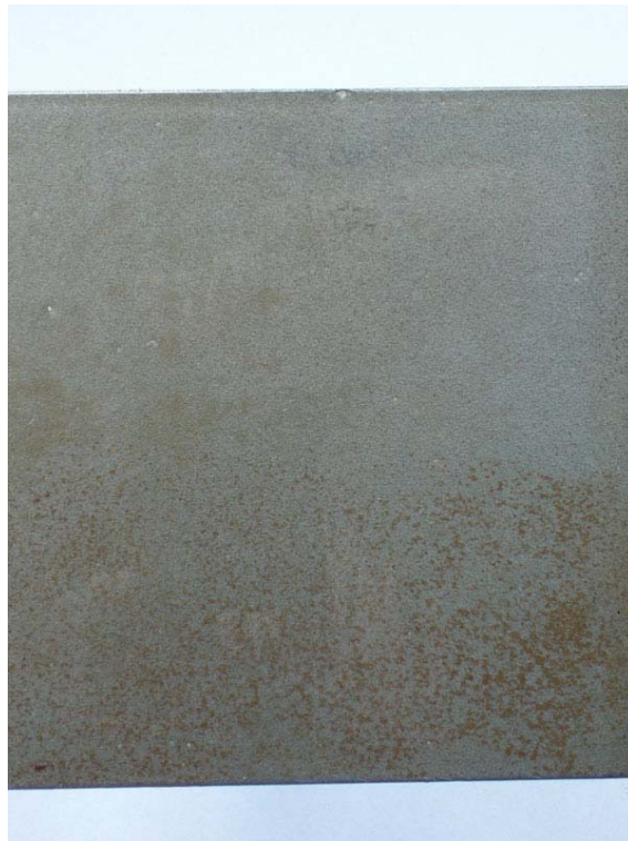
Bild 10: Stahlblech mit Alkydharz-Klarlack beschichtet
